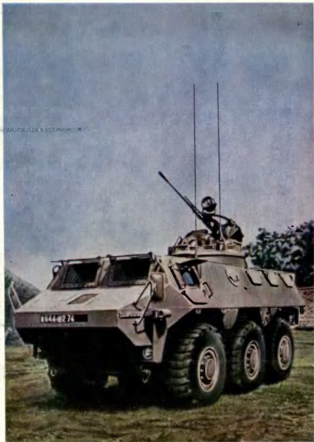
ФРАНЦУЗСКИЙ БРОНЕТРАНСПОРТЕР «САВИЕМ». В нем можно транспортировать 12 солдат с полным снаряжением или 2 т груза. Дизельный двигатель мощностью 245 л. с. обеспечивает движение с максимальной скоростью до 90 км/ч. Скорость на плаву 7 км/ч. Запас хода 1000 км
