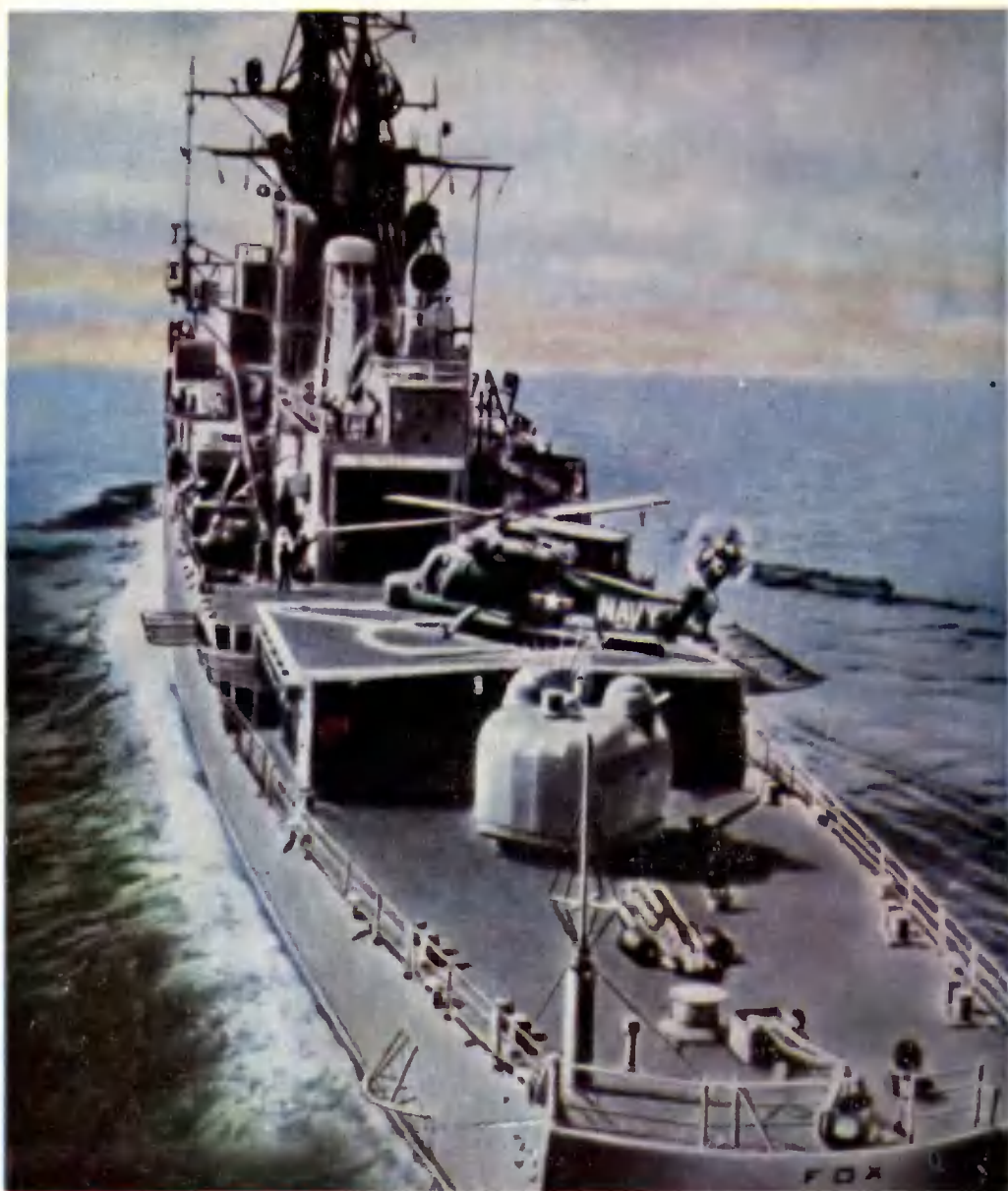
АМЕРИКАНСКИЙ КРЕЙСЕР УРО CG33 «ФОКС». Водоизмещение стандартное 6570 т, полное 7930 т; длина 166,7 м, ширина 16,7 м, осадка 8,7 м; мощность энергетической установки 85 000 л. с.; скорость хода 34 узла; вооружение: системы ЗУРО «Терьер», ПЛУРО «Ас-рон», 127-мм универсальная башенная артиллерийская установка, две 76-мм артиллерийские установки, два трехтрубных торпедных аппарата Mk32, вертолет SH-2D. Экипаж 418 человек, из них 31 офицер
